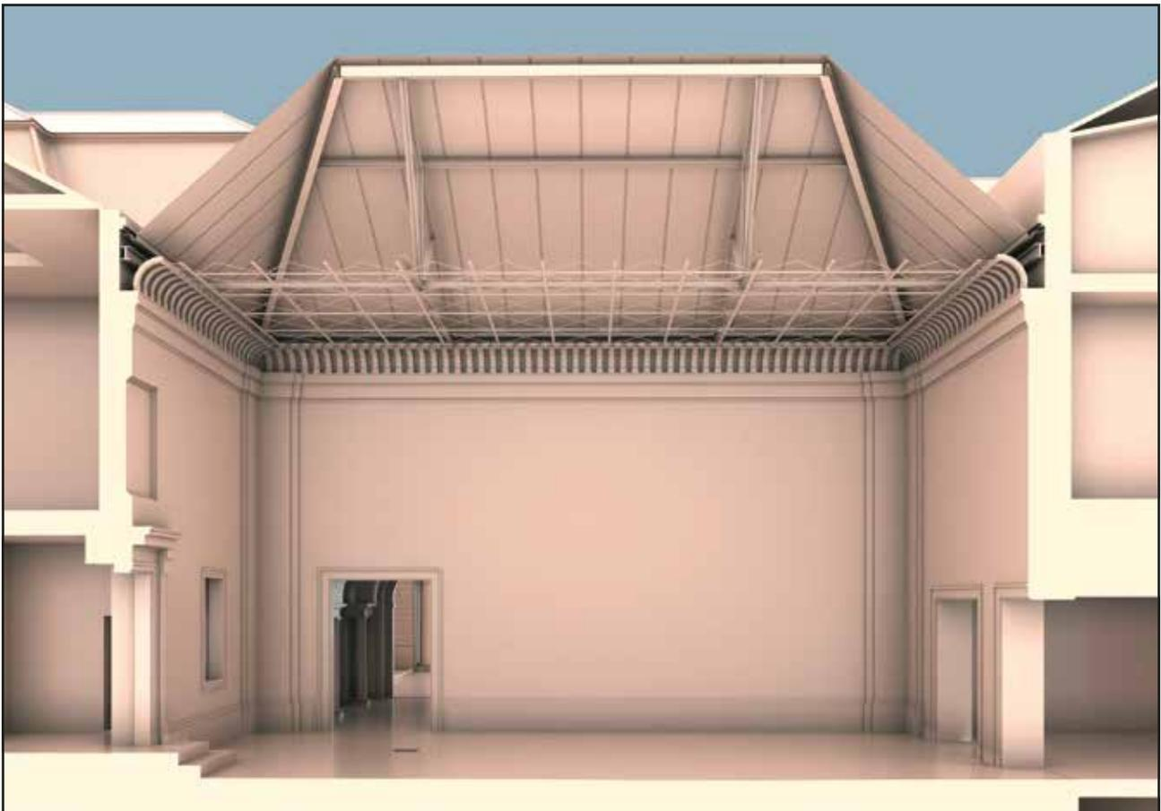
**Abb. 24** Längsschnitt durch den Kleinen Hof mit Glasdach und der an ihm angehängten Staubdecke
